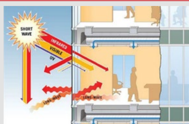
شکل ۲. پنجره‌های شیشه‌ای با پوشش نانویی که قابلیت فیلتر طول موج‌های ناخواسته را دارد.
