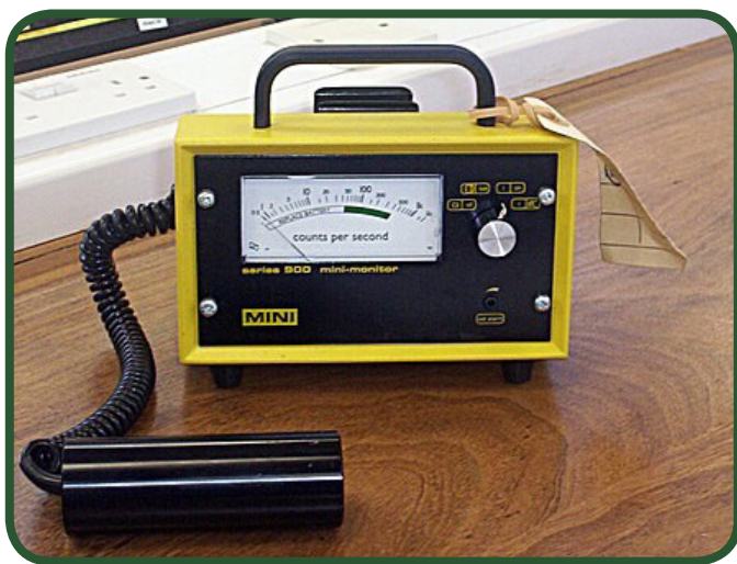
شکل ۱: یک آشکار ساز گایگر مولر
